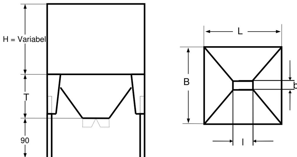
Silo Typ S mit einem Aufsatzring von 143 cm
